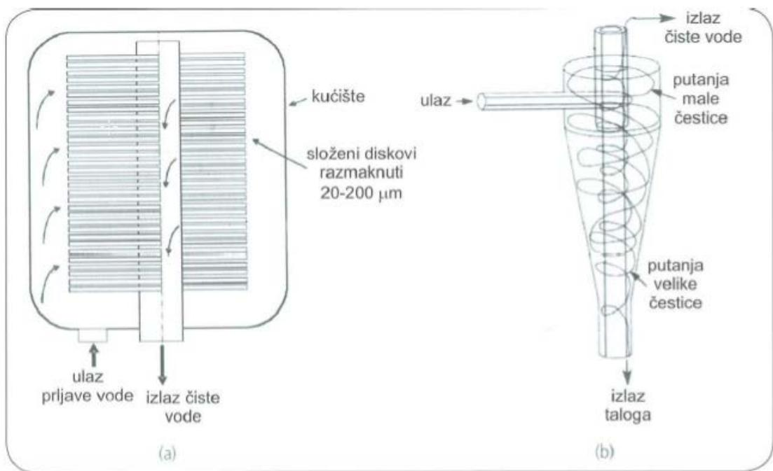
Slika 12.. Primarne metode obrade brodskog vodenog balasta[10]
