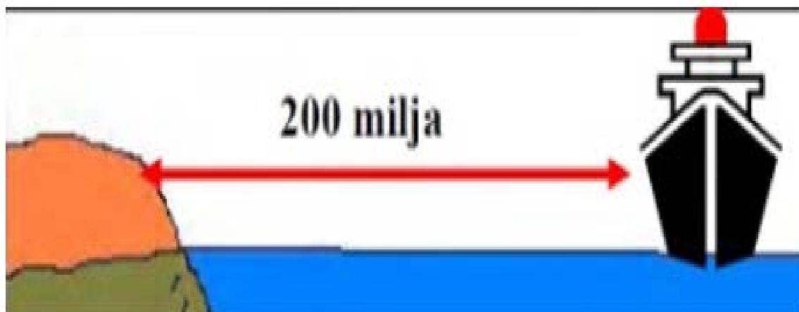
Slika 6. Najmanja udaljenost od obale za izmjenu balasta [3]
