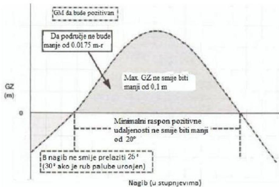
Slika 17. Prikaz kriterija stabilnosti u slučaju oštećenja broda [7]
