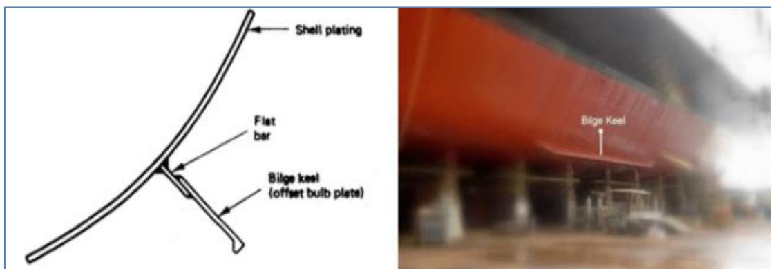
**Slika 18. Ljuljna kobilica - primjer pasivnih stabilizatora [16]**
