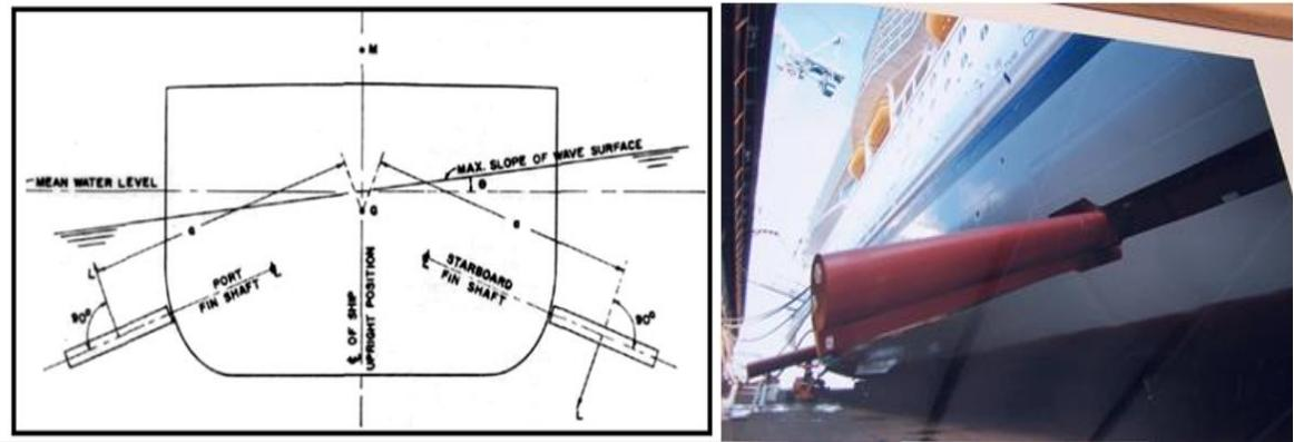
Slika 22. Shematski prikaz i slika sustava krilnih stabilizatora na brodovima [16]
