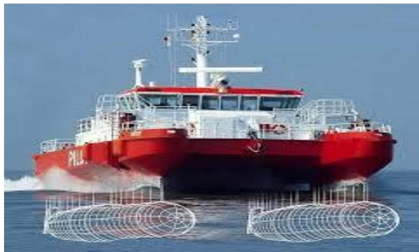
**Slika 8. Brod sa malom površinom vodene linije [preuzeto sa [www.bluebird-electric.net](http://www.bluebird-electric.net)]**
