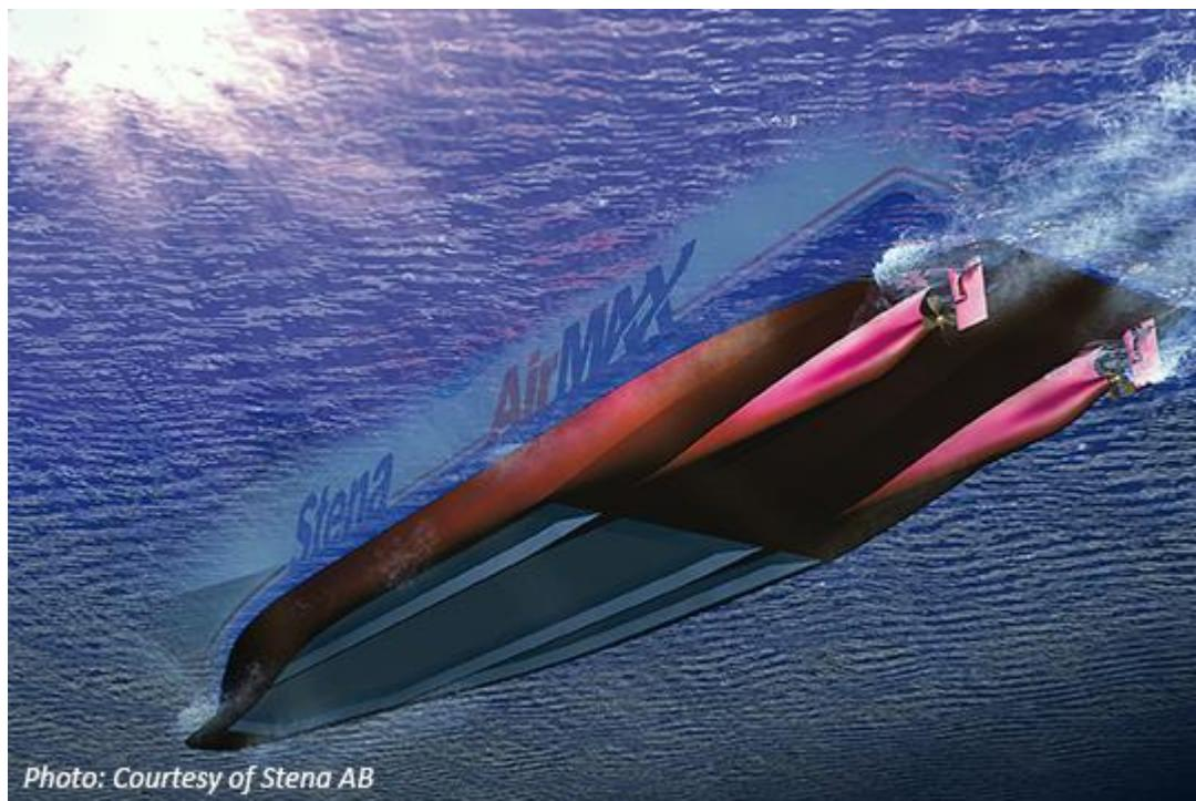
**Slika 9. Brod sa zračnom šupljinom [preuzeto sa [www.orbitalvector.com](http://www.orbitalvector.com)]**
