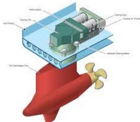
**Slika 23. Podtrupni potisnik [preuzeto sa [www.new.abb.com](http://www.new.abb.com)]**
