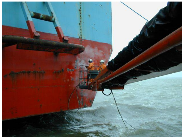
Slika 8. Čišćenje vodenim mlazom [11]
