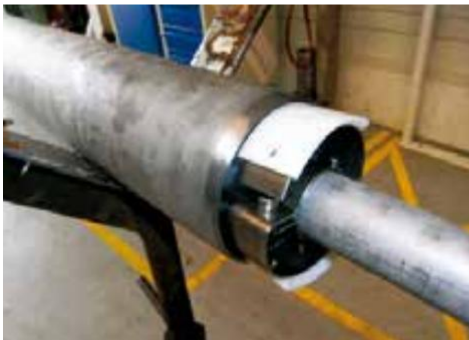
Slika 21. Izrada cijevi sa dvostrukom stjenkom [5]
