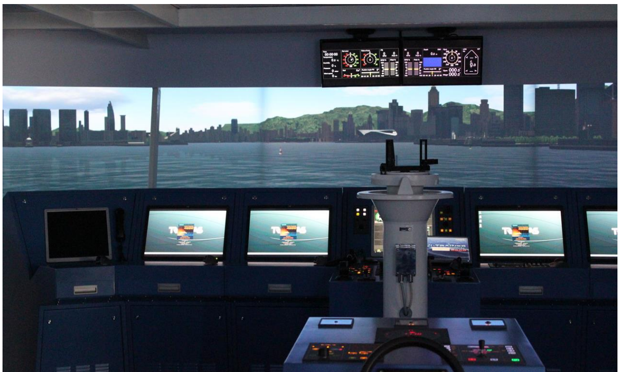
Slika 18 Simulator navigacijskog broda, fotografija simulatora PFST
