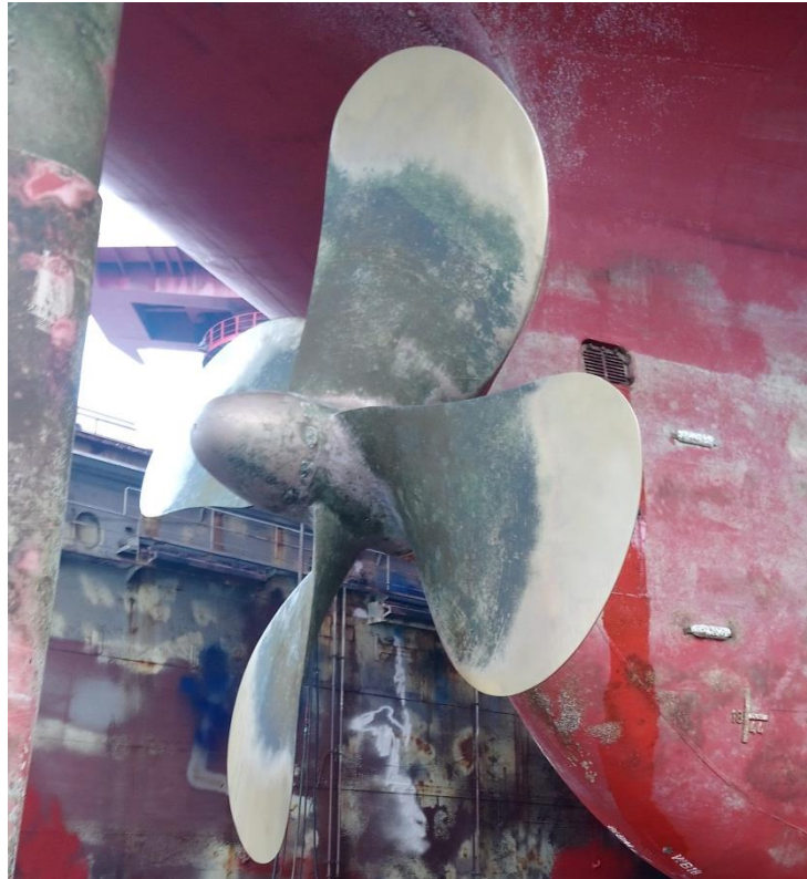
Slika 6. Desnokretni vijak sa fiksnim krilima
