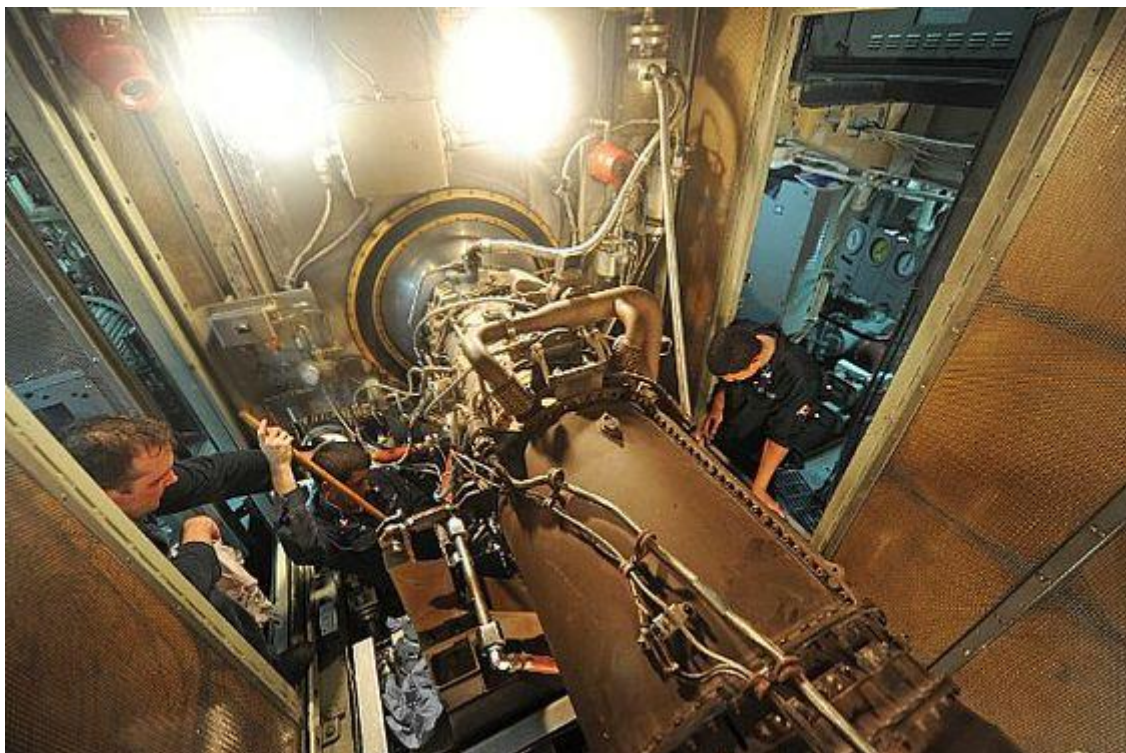
Slika 12. Servisiranje plinske turbine u brodskom postrojenju [12]
