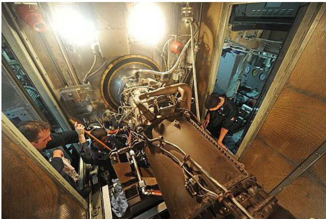
Slika 12. Servisiranje plinske turbine u brodskom postrojenju [12]
