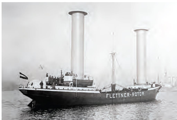
Slika 19. Brod Baden-Baden sa Flettnerovim rotorom [2]
