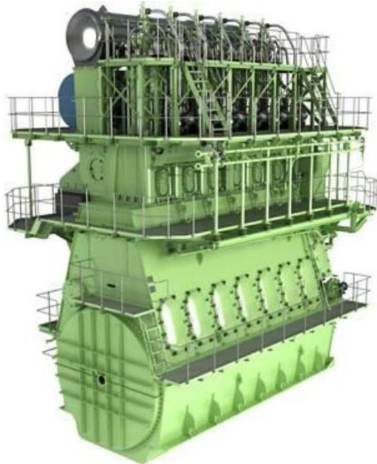
Slika 3. Sporookretni dvotaktni dizelski motor s prednabijanjem [1]
