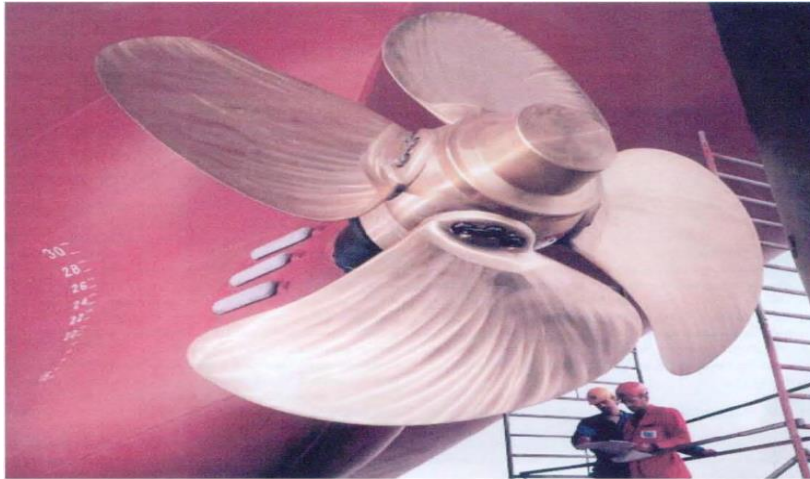
Slika 2. Primjer brodskog vijka sa upravljivim usponom[16]
