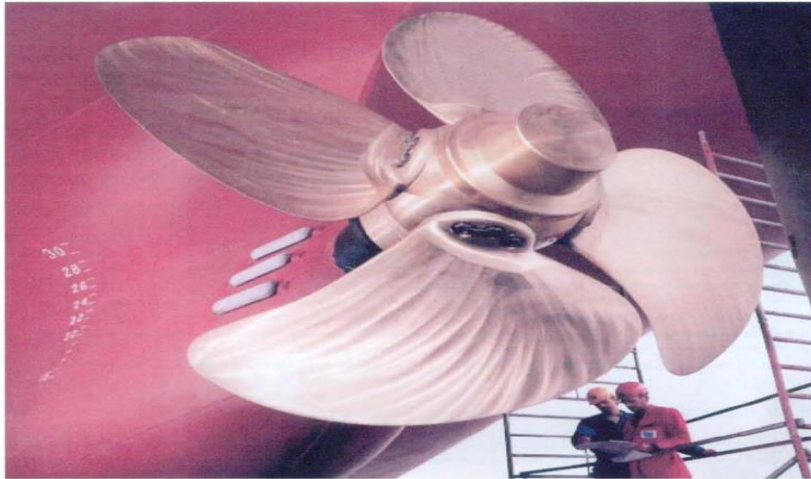
Slika 2. Primjer brodskog vijka sa upravljivim usponom[16]
