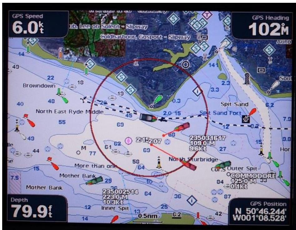
Slika 6. Prikaz ekrana AIS sustava [20]
