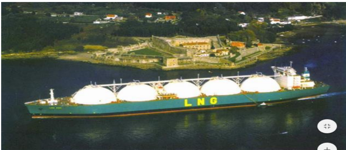
Slika 10. LNG tanker Moss – Rosenbergove izvedbe S.S. LNG Edo [1]
