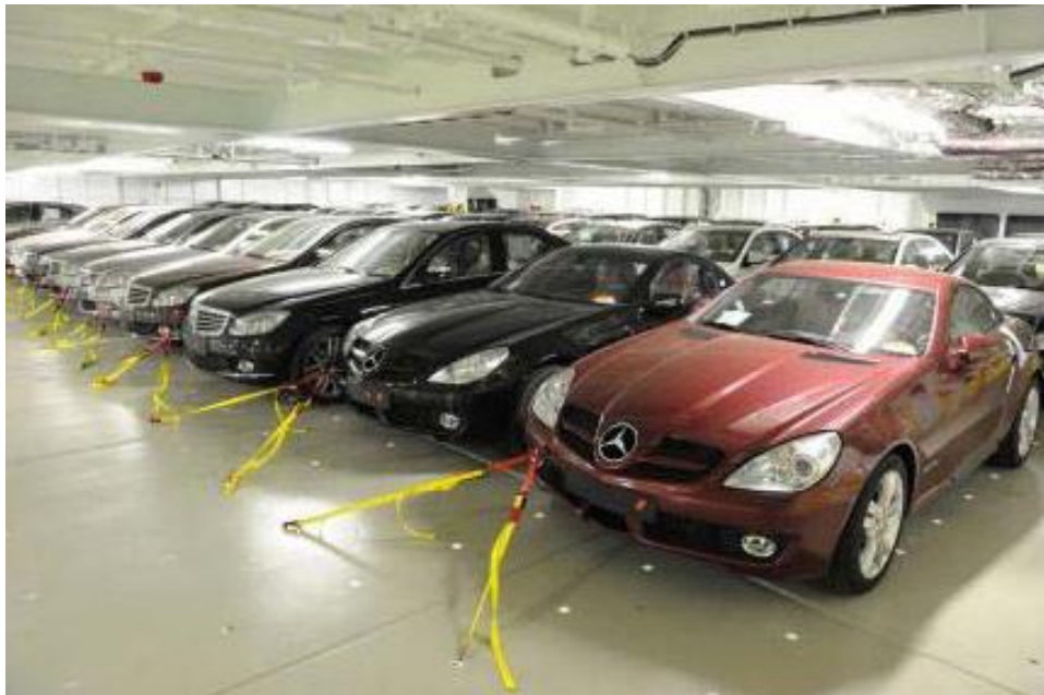
Slika 14. Prikaz osiguranja vozila žičanim načinom [6]
