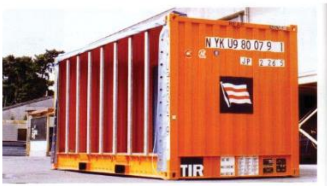
Slika 5. Kontejner s otvorenim krovom i stranicama
