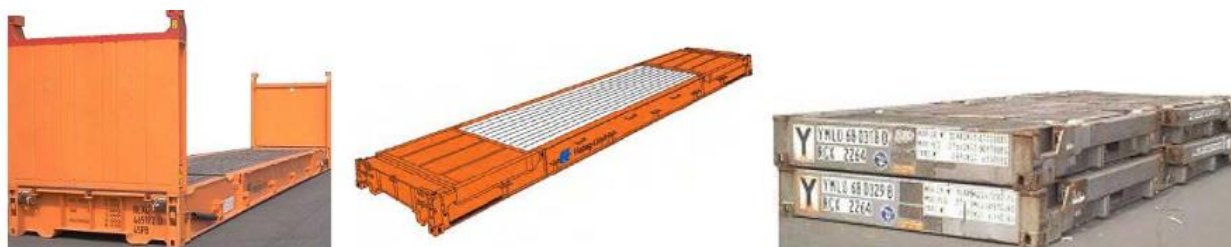
Slika 11. 20' i 40' kontejnerska platforma
