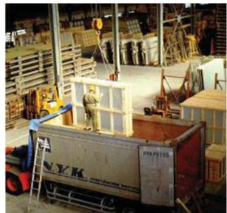
Slika 5. Kontejner s otvorenim krovom i stranicama
