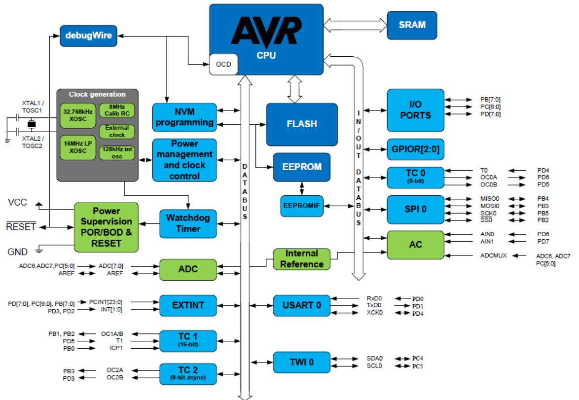
**Slika 8. Blok dijagram mikrokontrolera**
