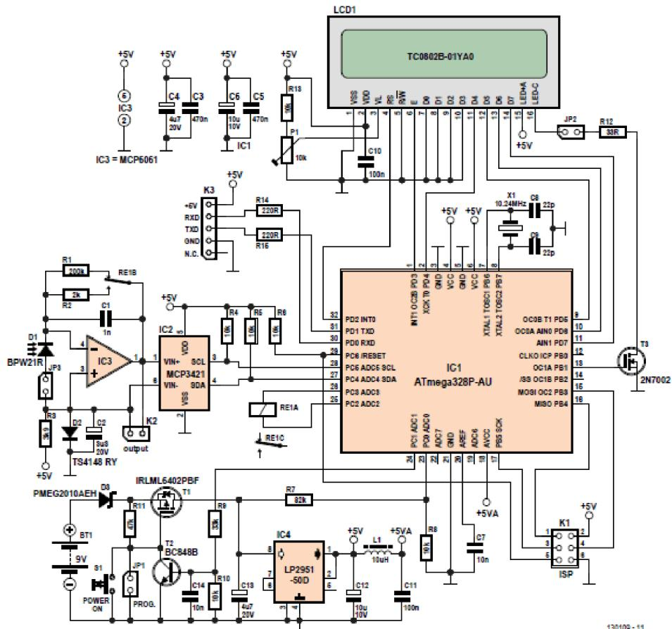
Slika 7. Model sklopa za mjerjenje razine osvijetljenosti
