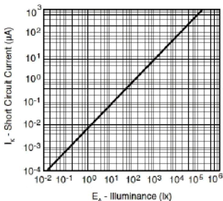
Slika 10. Omjer struje kratkog spoja i razine osvijetljenosti
