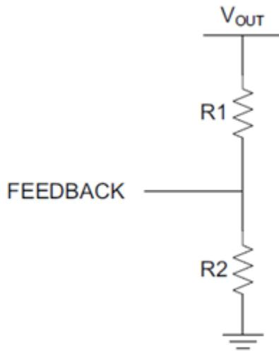
**Slika 16. Sklop struje FEEDBACK-a**
