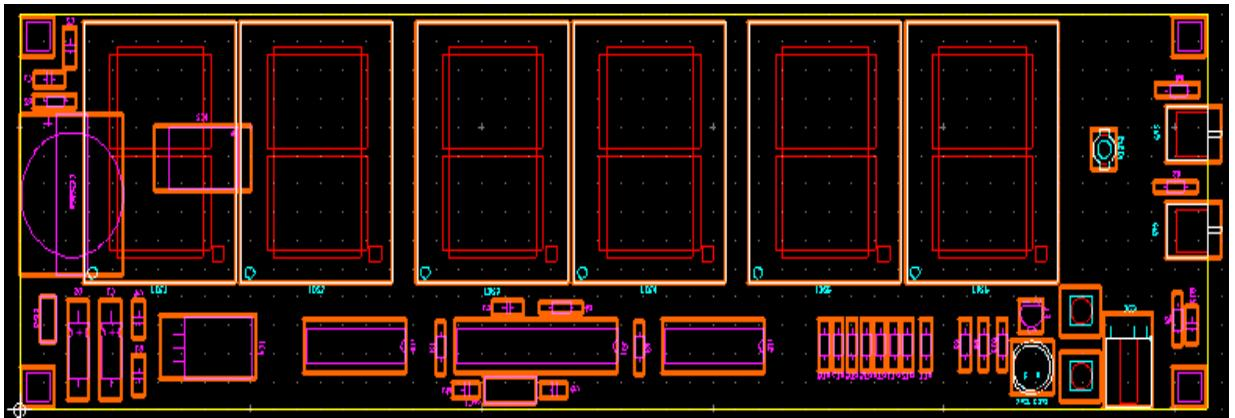
**Slika 5.2 Konačni dizajn pločice za digitalni sat**
