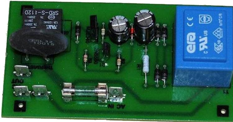
Slika 4.1 Jednoslojna tiskana pločica
