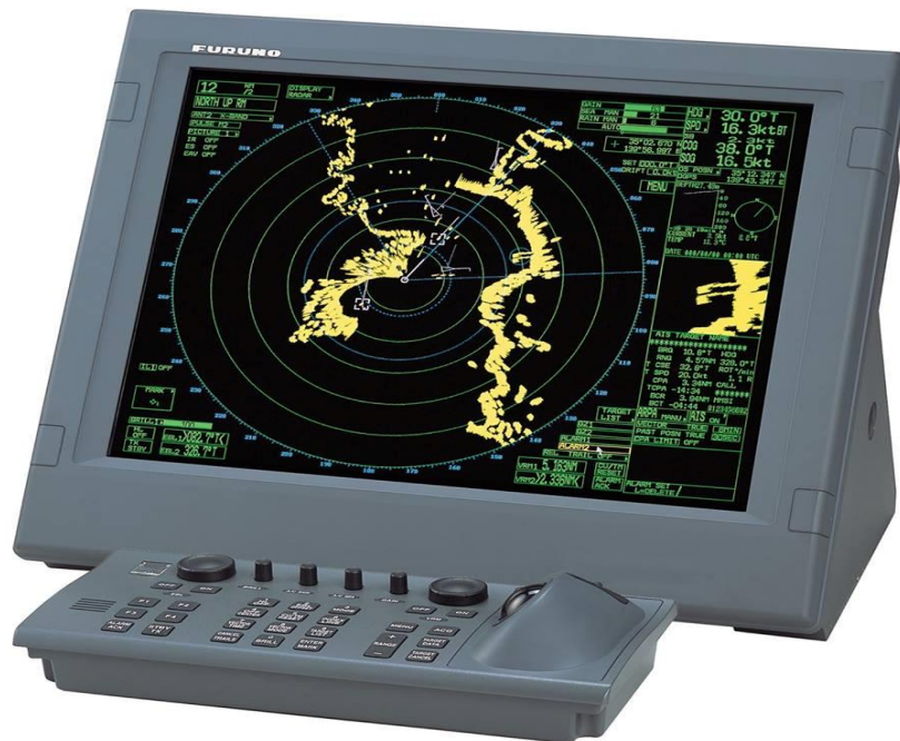
Slika 2. Moderni ARPA radar[12]
