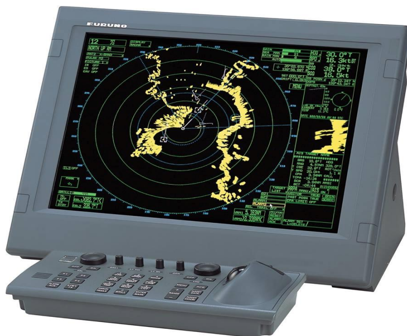
Slika 2. Moderni ARPA radar[12]
