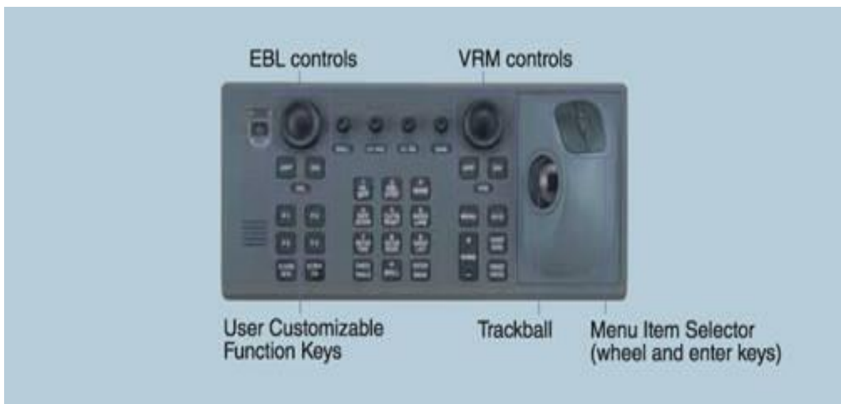
Slika 5. Osnovne kontrole radara[14]
