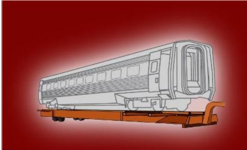
Slika 5. Spuštena ro-ro prikolica[22]
