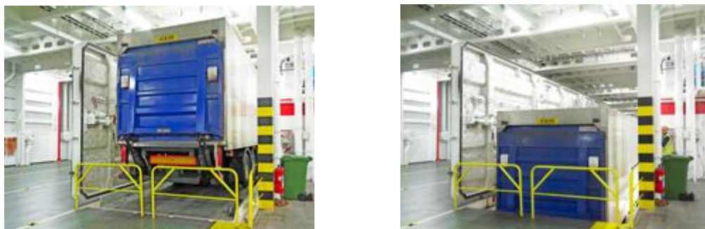
Slika 9. Proces spuštanja unutarnjeg dizala[24]
