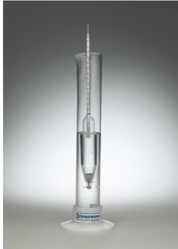
Slika 17. Mjerač temperature i spec. gustoće i laboratorijska čaša [2]
