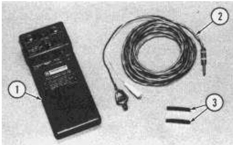
Slika 23. Indikator točke ispitivanja [2]
