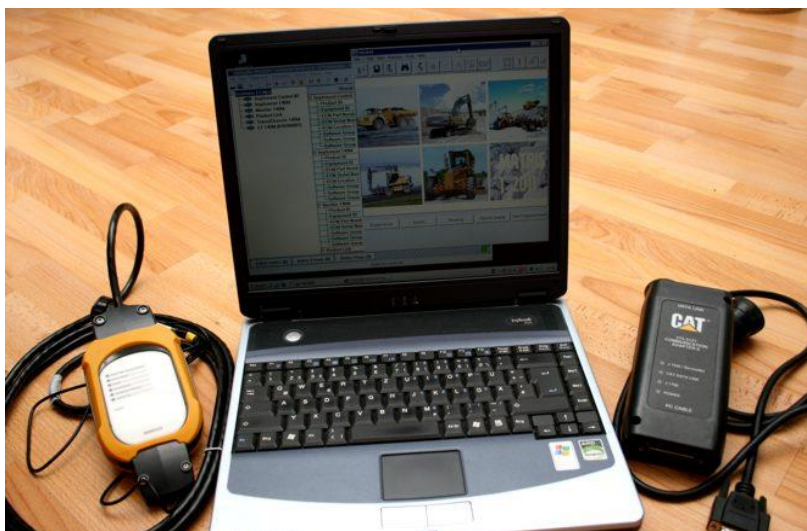
Slika 11. Laptop s instaliranim Caterpillar servisnim alatom [2]
