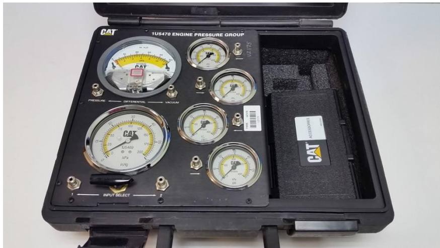
Slika 15. Caterpillar grupacija 6 vakuumskih presostata [2]
