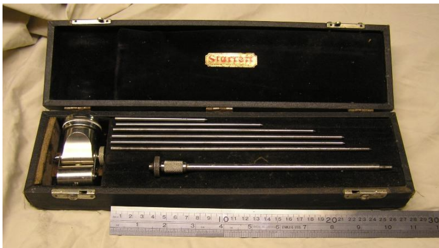
Slika 24. Indikator otklona koljenastog vratila [2]
