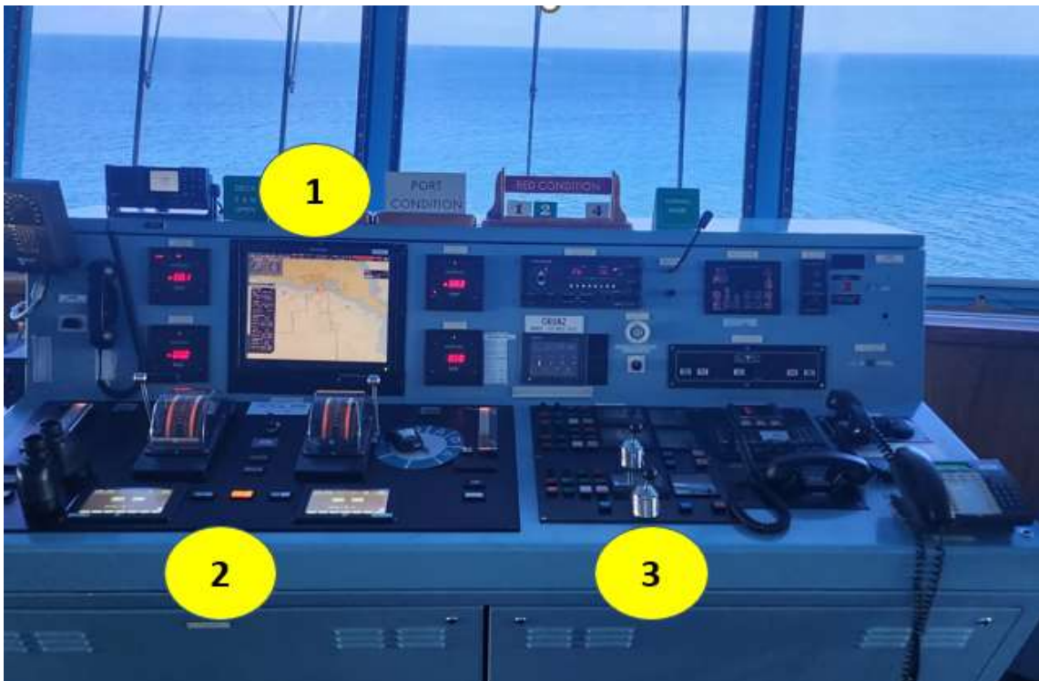
Slika 11. Stanica za upravljanje kontrolama propulzije
