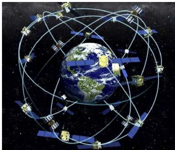
Slika 17. Konstelacija GLONASS satelitskog navigacijskog sustava [29]
