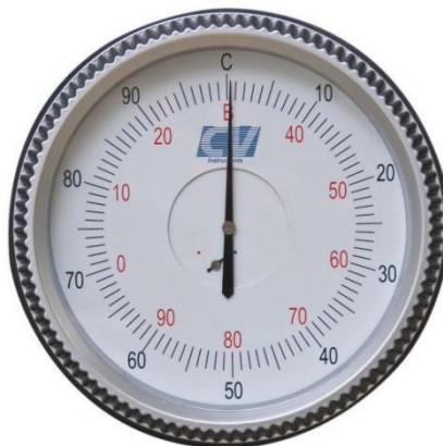
Slika 17. Analogni indikator broja tvrdoće HRB (brojevi u crvenoj boji) i HRC (brojevi u plavoj boji).
