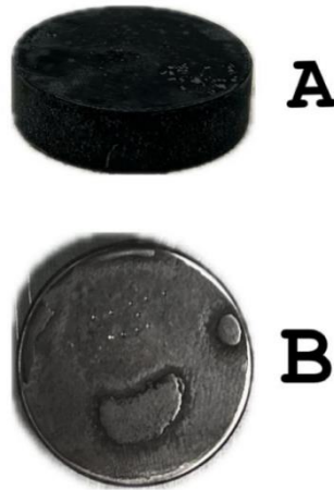
Slika 19. Uzorak toplinske obrade žarenja, prije (A) i poslije brušenja (B).
