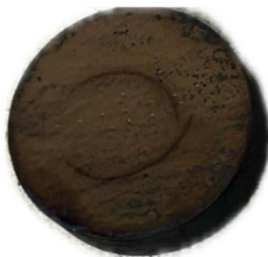
Slika 21. Pukotina na uzorku "Kaljenje vodom".
