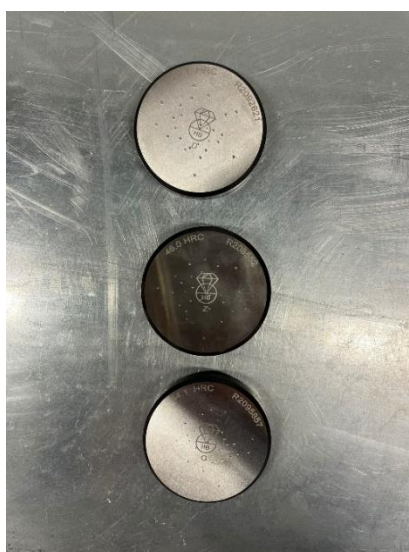
Slika 9. Primjeri standardnih blokova za ispitivanje tvrdoće po metodi Rockwell (a) 29,1HRC, (b) 46,0 HRC i (c) 64,1 HRC
