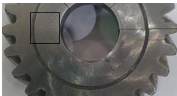
Slika 26. Područje (crni kvadrat) gdje je izmjerena tvrdoća
