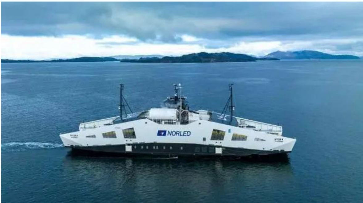
Slika 28. MF Hydra, hibridni brod koji koristi i baterije i gorivne članke na tekući vodik [44]
