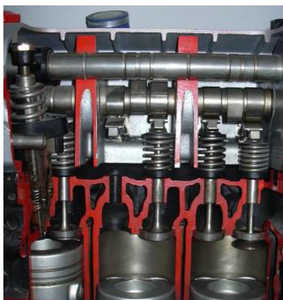
**Slika 6. Presjek bloka motora [6]**
