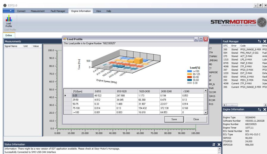
**Slika 30. Prikaz statistike profila motora [5]**
