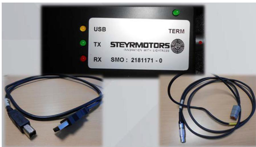
**Slika 11. Modul za spajanje motora i dijagnostičkog alata [5]**
