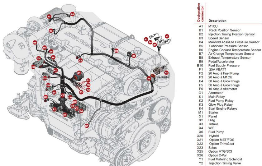
**Slika 9. Prikaz elektroničke opreme motora [6]**
