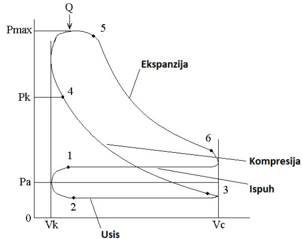
**Slika 2. Rad četverotaktnog motora u P-V dijagramu (realni proces) [7]**
