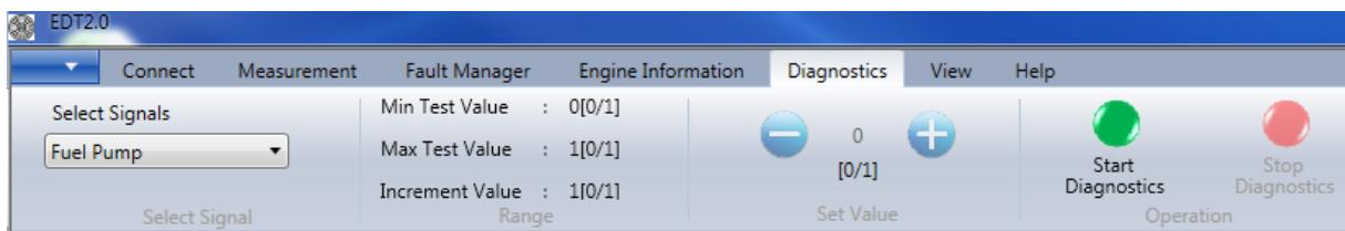
Slika 28. Prikaz primjera aktiviranja pumpe goriva [5]
