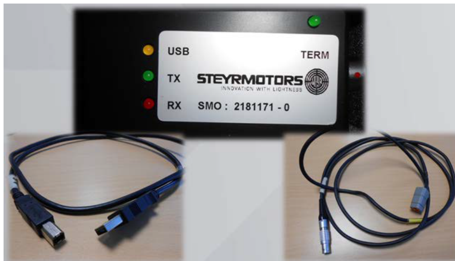
Slika 11. Modul za spajanje motora i dijagnostičkog alata [5]
