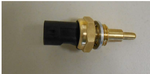
Slika 21. Osjetnik temperature ispušnih plinova [6]
