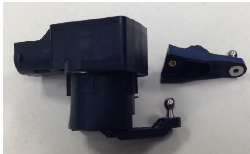
Slika 22. Potenciometar za regulaciju opterećenja [6]
