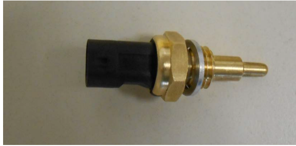
Slika 19. Osjetnik temperature sustava rashlada [6]
