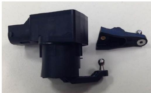
**Slika 22. Potenciometar za regulaciju opterećenja [6]**
