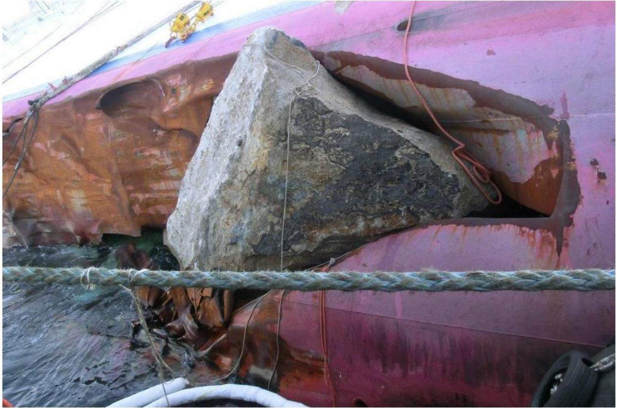
Slika 18. Zaglavljena stijena u oštećenom području [3]
