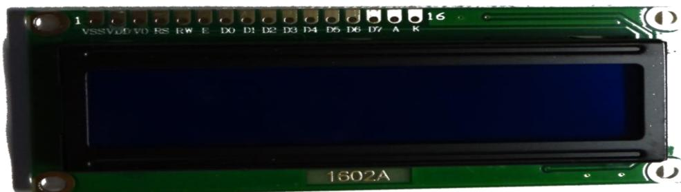
Slika 6. 1602A LCD module
