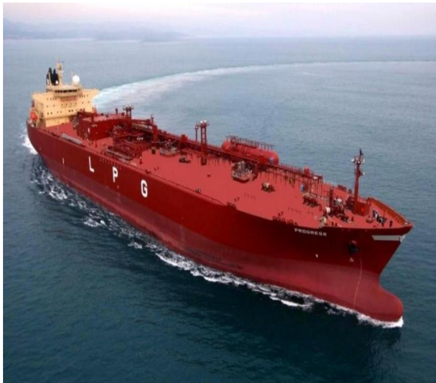
Slika 9 VLGC brod za prijevoz ukapljenog naftnog plina [7]
