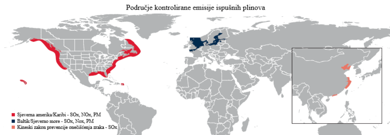
Slika 16. Područje kontrolirane emisije ispušnih plinova [20]
