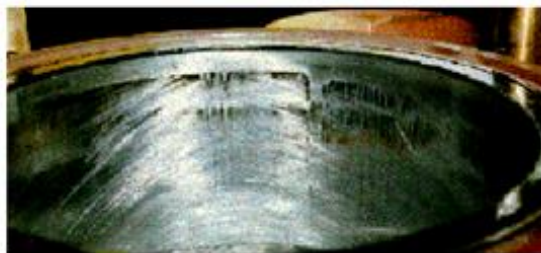
Slika 17. Pepelom oštećene površine košuljica [10]
