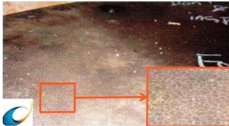
Slika 21. Kontinuirani gubitak materijala na čelu stapa, takozvana 'kaldrma' odnosno 'slonovska koža' [12]
