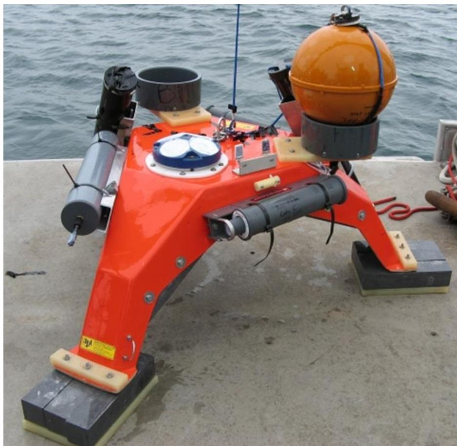
**Slika 10. ADCP strujomjer – “Sea Spider” s ugrađenim ADCP strujomjerom [11]**
