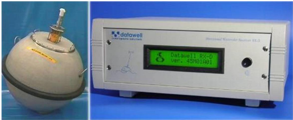
**Slika 14. Mjerna plutača s odašiljačem i prijemna stanica valomjera tvrtke
