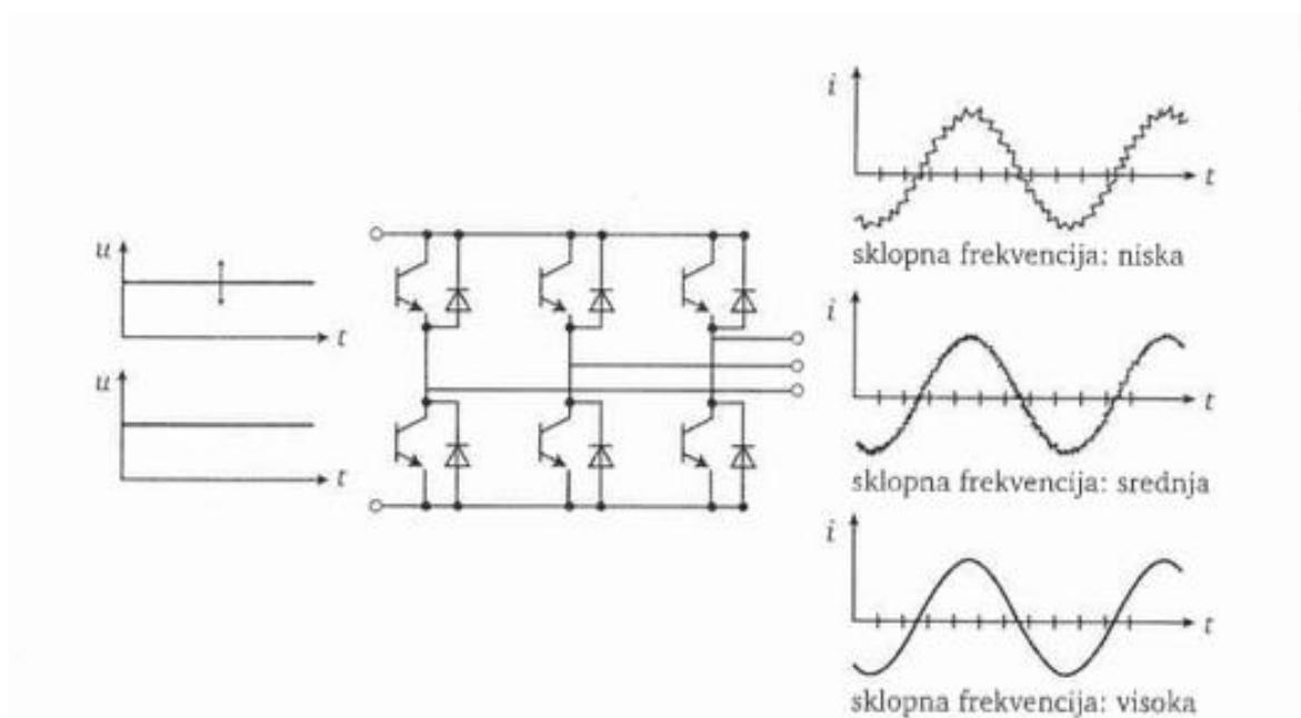
Slika 9. Izmjenjivač s utisnutim promjenjivim ili konstantnim naponom [2]
