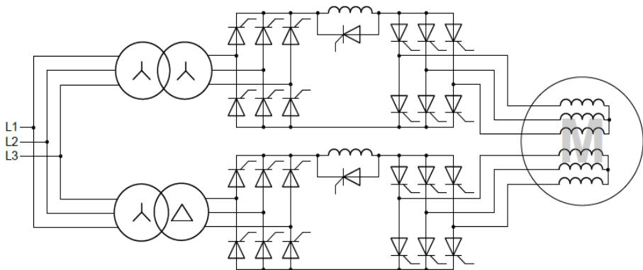
Slika 15. Sinkrokonverter u para-12-pulsnoj konfiguraciji 8 [4]
