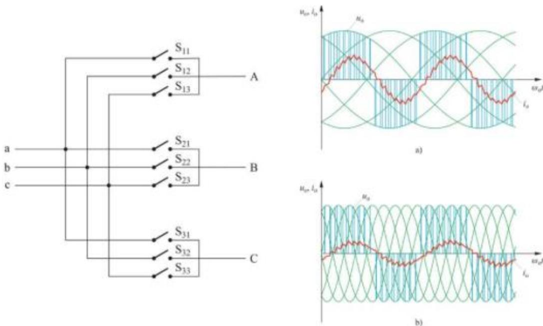
Slika 2. Izravni frekvenčijski pretvarač s prikazom valnoga oblika izmjeničnoga napona. [1]
