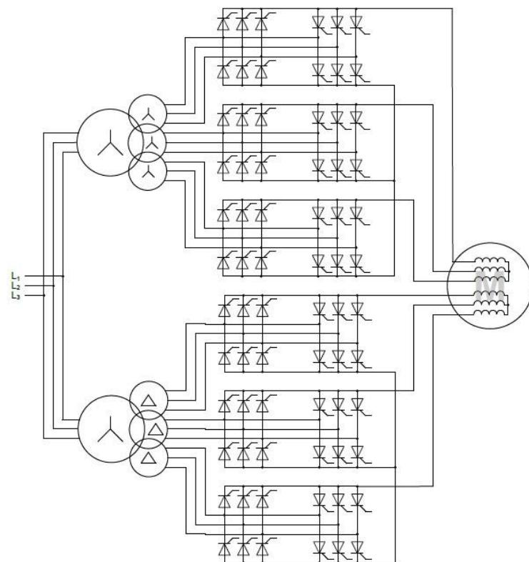
Slika 16. Ciklokonverter u para-12-pulsnoj konfiguraciji [4]
