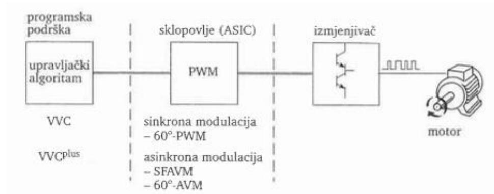
Slika 11. Prikaz načela upravljanja Danfossovim izmjenjivačima [2]
