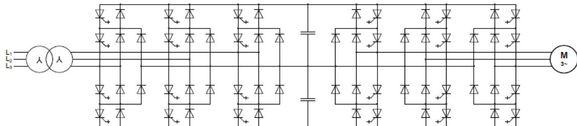
Slika 17. Visokonaponski ŠIM pretvarač frekvencije s tri nivoa napona i aktivnim ŠIM ispravljačem
