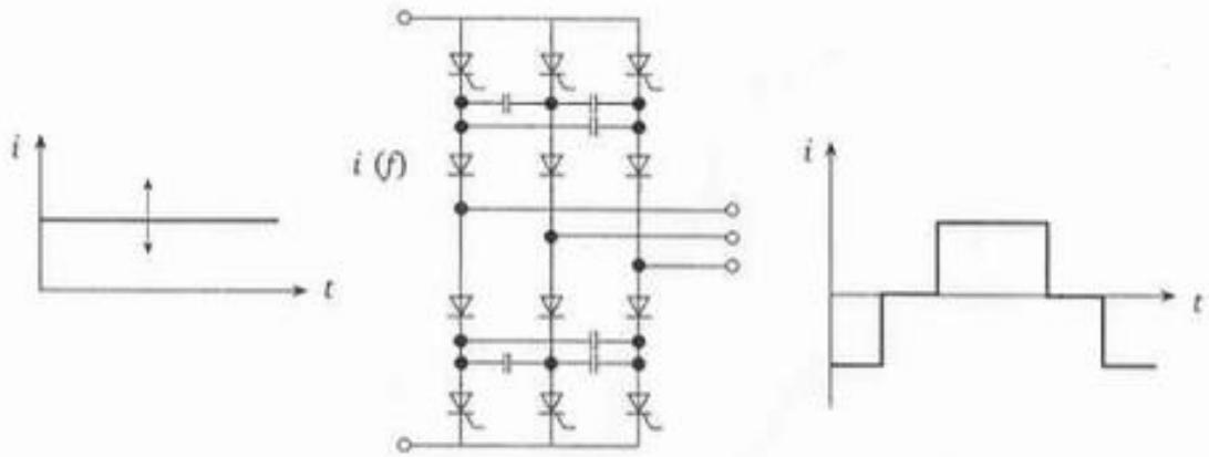
Slika 8. Klasični izmjenjivač s promjenjivim naponom strujnoga međukruga [2]
