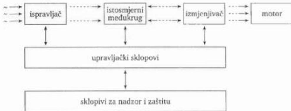
Slika 3. Pojednostavljeni prikaz sheme neizravnog frekvencijskoga pretvarača [2]
