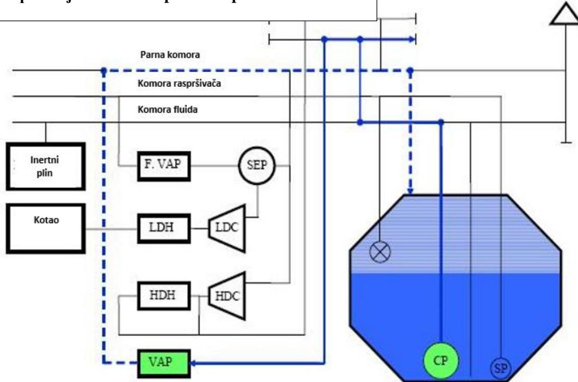
Slika 7. Ispuštanje LNG-a bez povratka plina [1]
