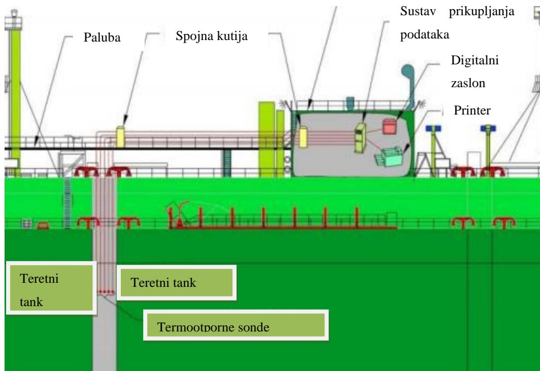
**Slika 10. Dijagram uređaja za mjerjenje temperature na LNG brodu**
