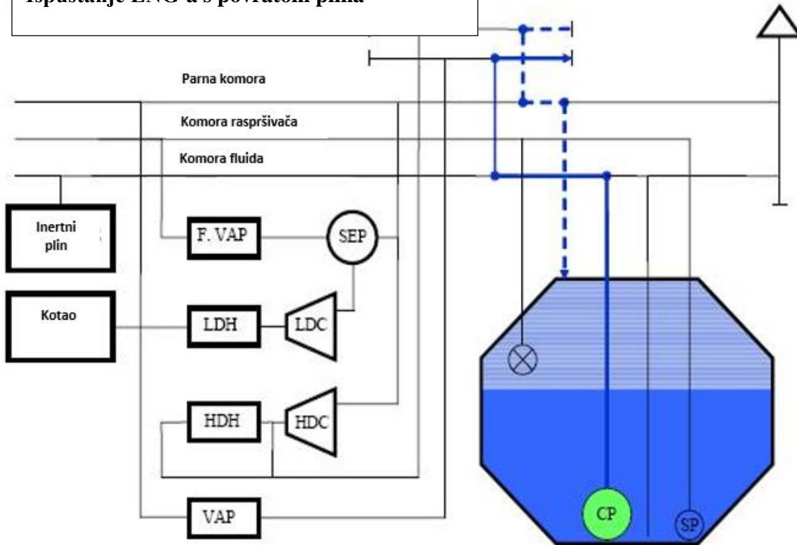
Slika 6. Ispuštanje LNG-a s povratom plina [1]
