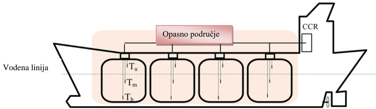
**Slika 11. Mjerenje temperature na LNG brodu [9]**
