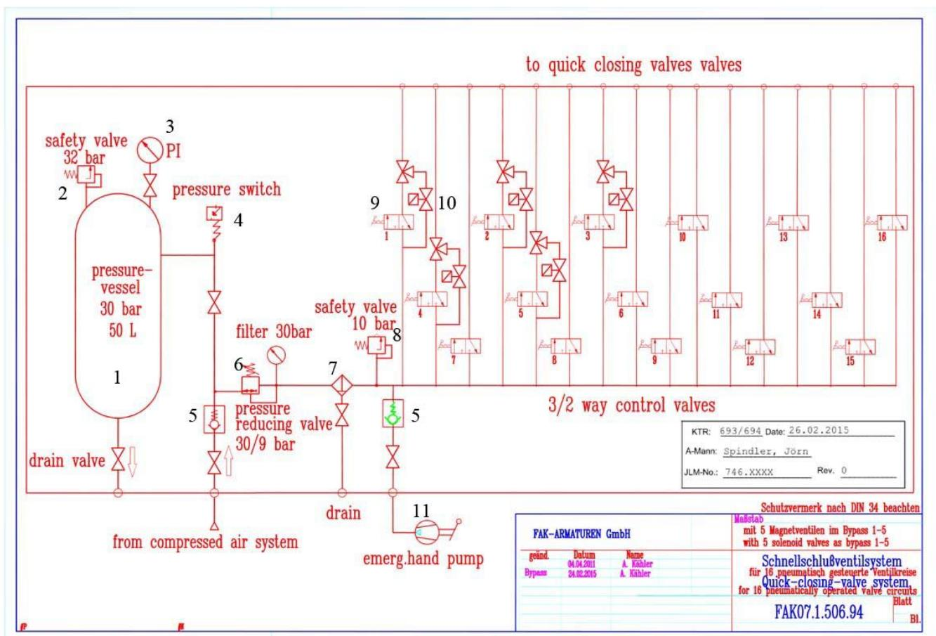
1-spremnik zraka, 2-sigurnosni tlačni ventil 32 bar (ventil za ograničenje tlaka), 3-manometar, 4-tlačna sklopka, 5-nepovratni ventil, 6-regulator tlaka s manometrom, 7-filter zraka s ispustom kondenzata, 8-sigurnosni tlačni ventil 10 bar (ventil za ograničenje tlaka), 9-ručno aktivirani 3/2 razvodnik zraka s uskočnikom, 10-elektronski ventil
