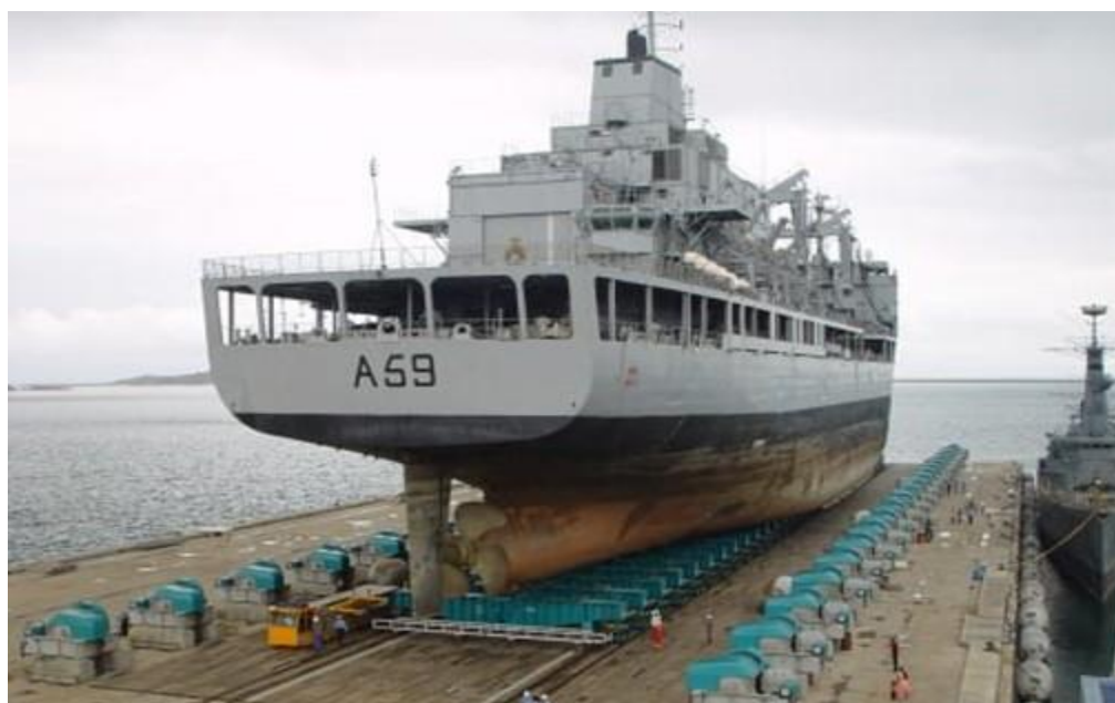
Slika 2. Brod u syncro-liftu [4]
