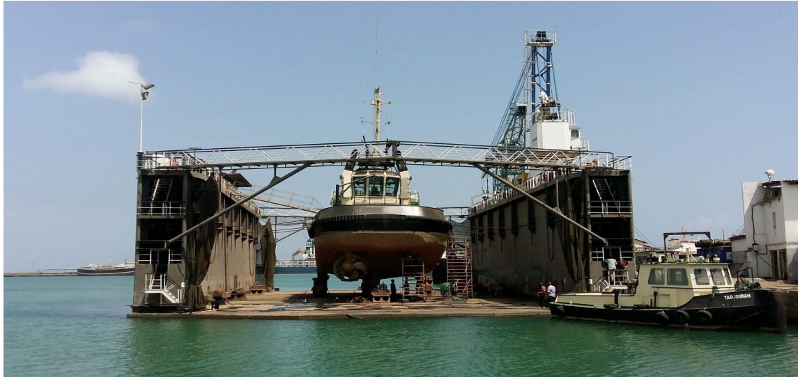
Slika 4. Brod u plutajućem doku [4]
