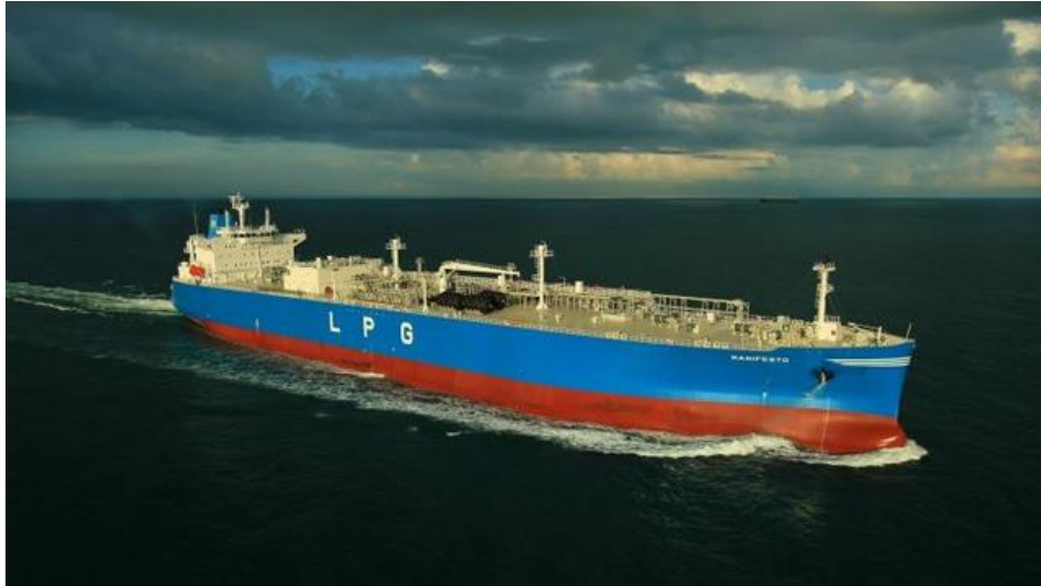
Slika 7. Potpuno hlađeni LPG tanker [11]
