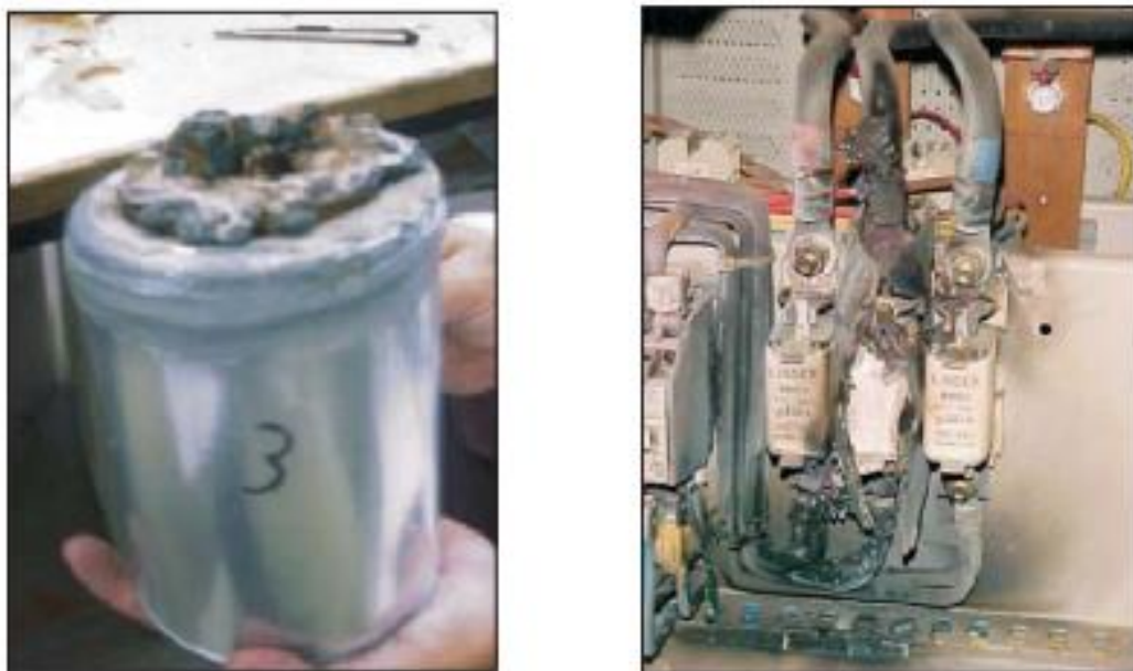
Slika 17. Posljedice rezonancije na frekvencijama viših harmonika [6]
