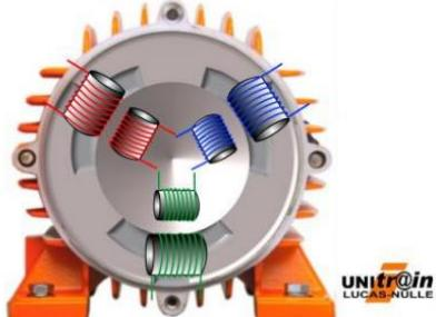
**Slika 8. Poprečni presjek korištenog motora [4]**
