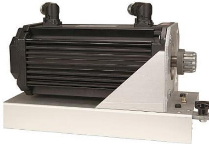
**Slika 23. Ispitni stol za servo strojeve [5]**
