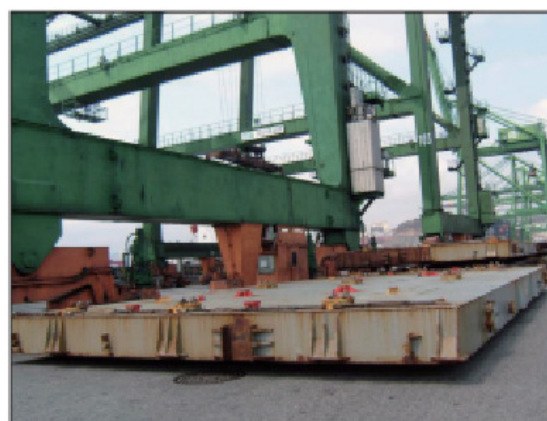
Odloženi poklopci na terminalu za vrijeme prekrcaja tereta
