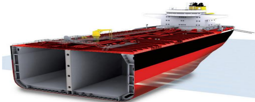
Slika 15. Presjek trupa s dvodnom [14]
