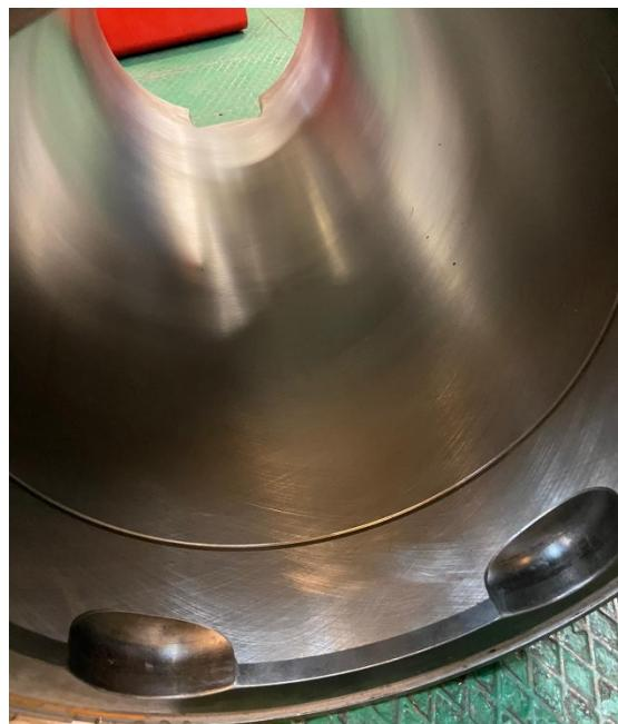
Slika 21. Honirana površina košuljice cilindra četverotaktnog motora [4]
