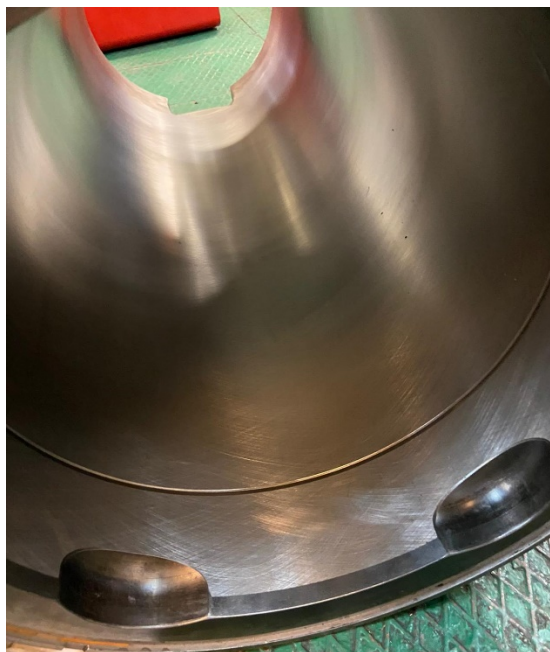
Slika 21. Honirana površina košuljice cilindra četverotaktnog motora [4]
