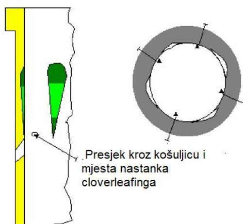
Slika 19. Shematski prikaz nastanka istrošenja [2]
