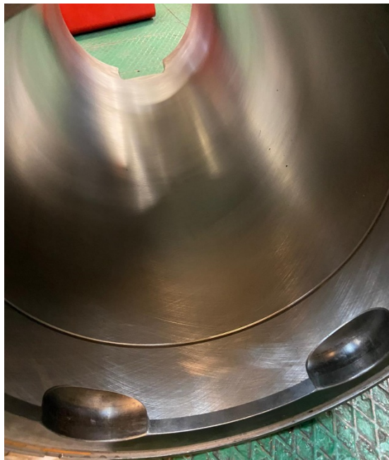
Slika 21. Honirana površina košuljice cilindra četverotaktnog motora [4]
