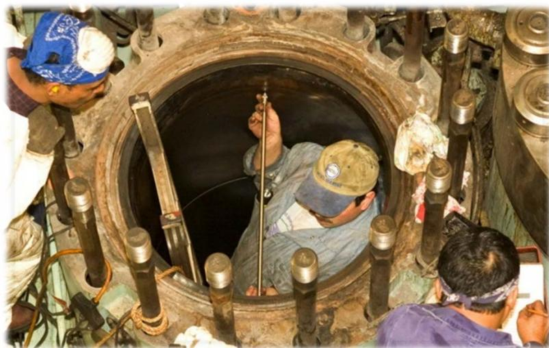
Slika 22. Mjerjenje trošenje košuljice mikrometrom [1].
