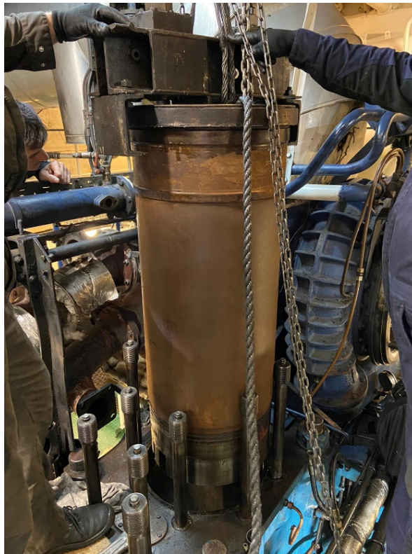
Slika 7. Stvarni prikaz vanjske strane košuljice cilindra [4]
