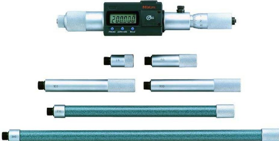
Slika 4. Mikrometar za mjerjenje unutrašnjeg promjera [19]
