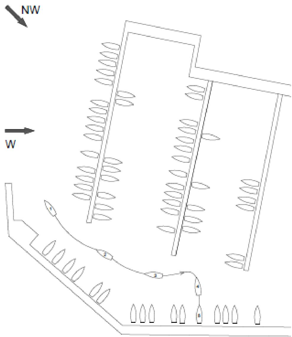
Slika 20. Uplovljavanje na lukobran (zapadni i sjeverozapadni vjetar)
