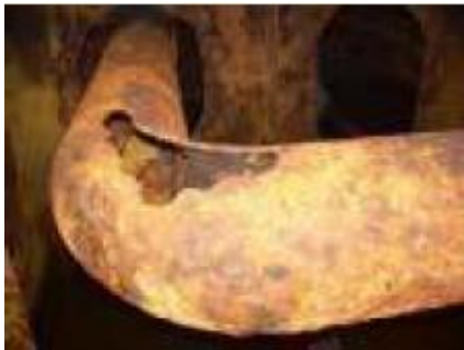
Slika 16. Oštećenja cijevi: a) cijev koju treba trajno sanirati; b) privremeni popravak (Prema: Ivošević, Špiro, Održavanje i bezbjednost broda , 2016.)
