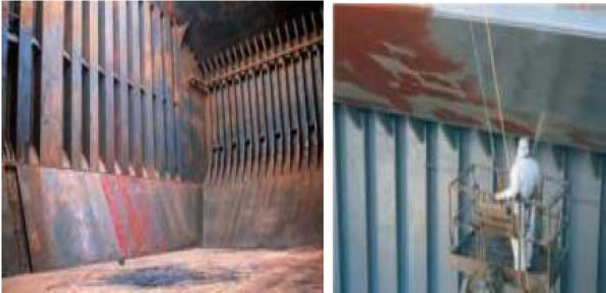
Slika 10. Izgled skladišta nakon iskrcaja tereta i bojanje gornjeg dijela skladišta (Prema: Ivošević, Špiro, Održavanje i bezbjednost broda , 2016.)
