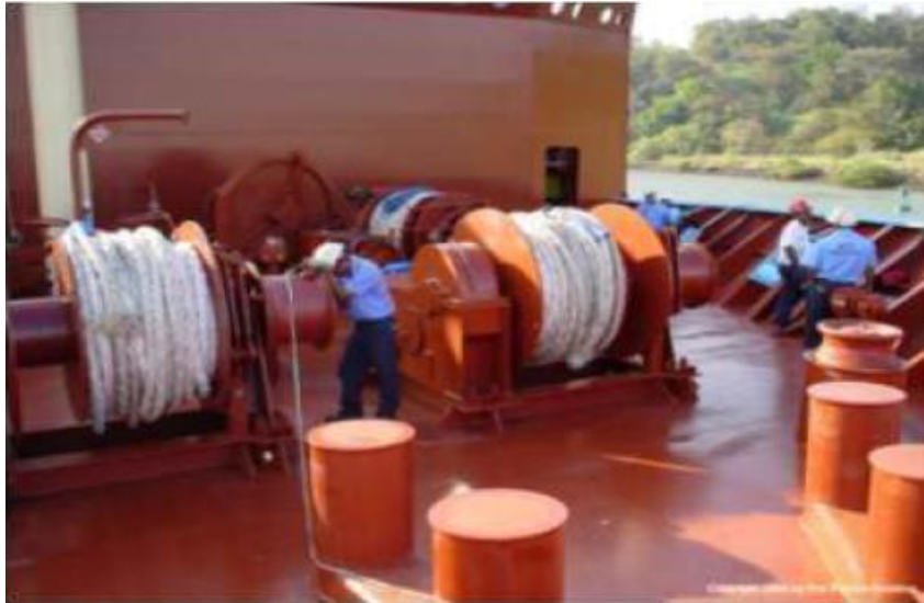
Slika 7. Održavanje konopa na priteznom vitlu (Prema: Ivošević, Špiro, Održavanje i bezbjednost broda , 2016.)
