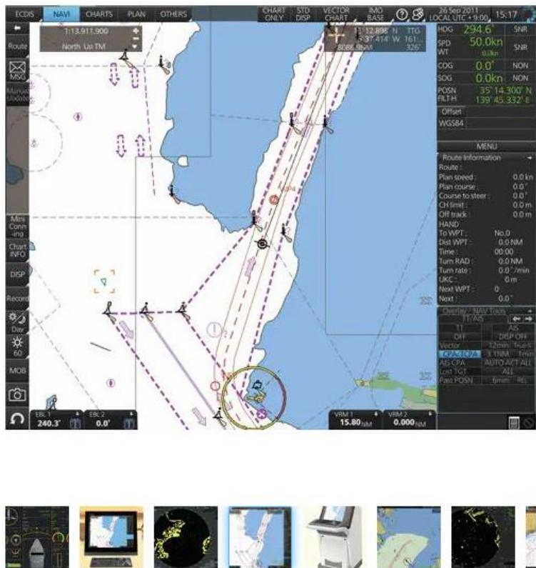
Slika 2. Izgled tipičnog ekrana ECDIS sustava
