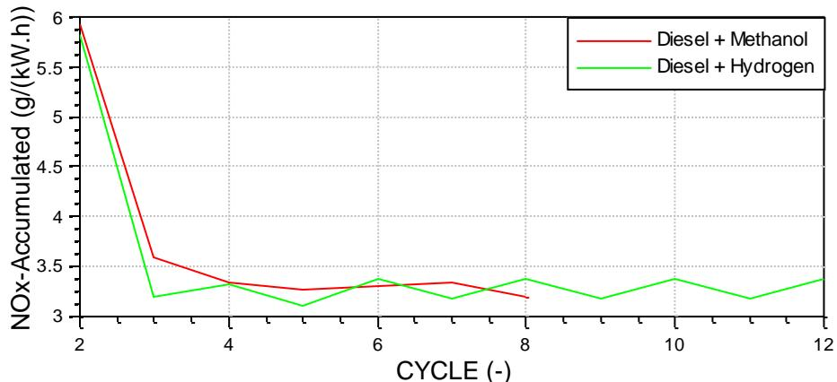
**Slika 75. Rezultati simulacija NOx-a smjesa metanola i vodika s dizelom**
