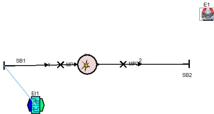
Slika 10. Pojednostavljeni model motora unutar AVL Boost-a
