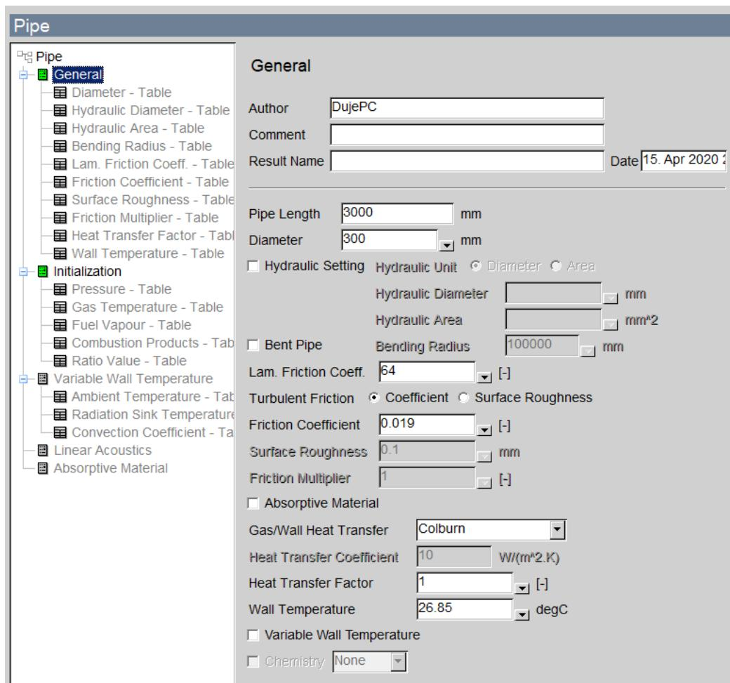
**Slika 49. Općenite veličine pojednostavljene cijevi ispuha**
