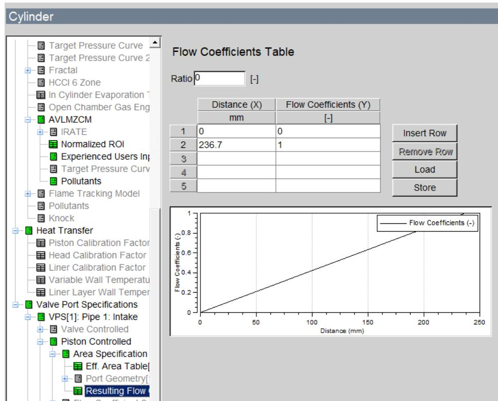
Slika 34. Graf protoka zraka usisa u cilindar
