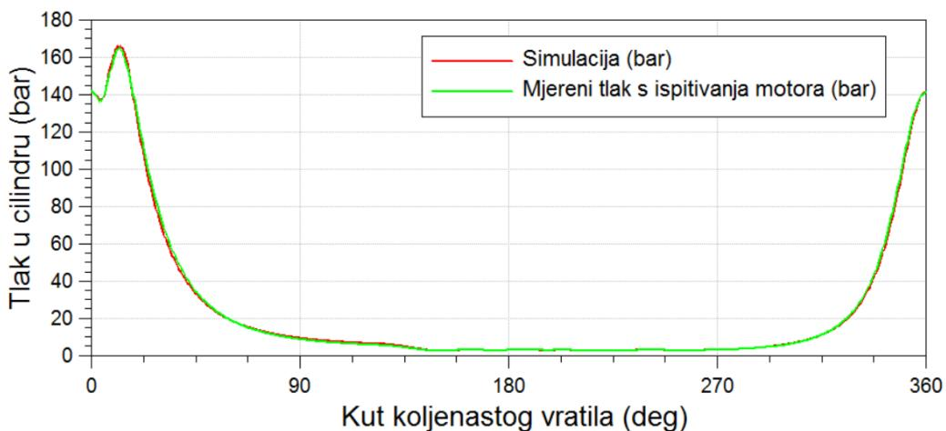
**Slika 55. Usporedba ispitivanog motora i simulacije [19]**
