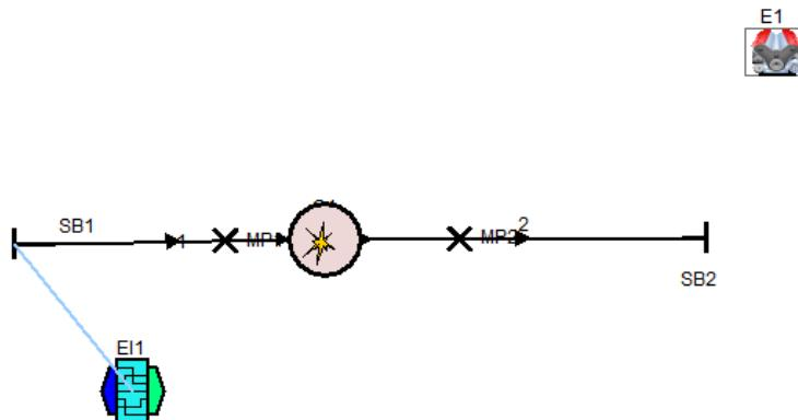
**Slika 13. Pojednostavljeni model motora unutar AVL Boost-a**
