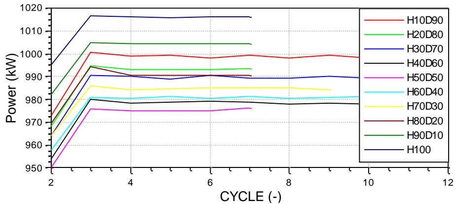
**Slika 68. Rezultati simulacija snage smjesa vodika i dizela**
