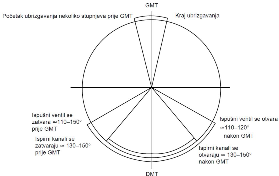
**Slika 7. Ciklus dvotaktnog sporokretnog dizelskog motora [19]**
