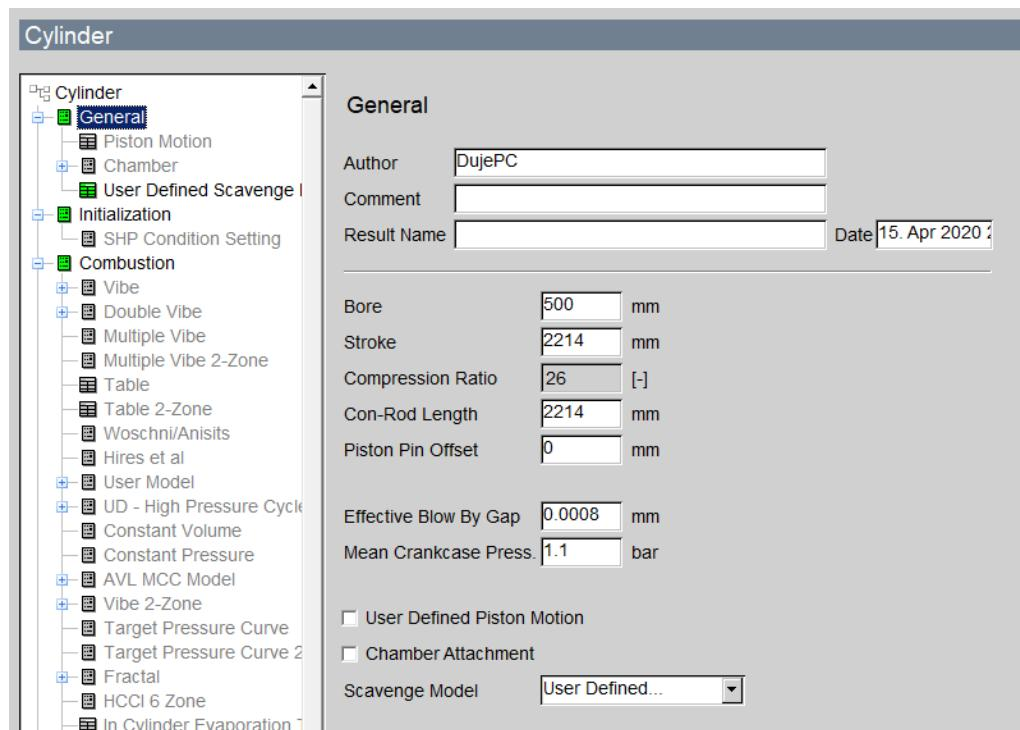
**Slika 21. Osnovne mjere motora**
