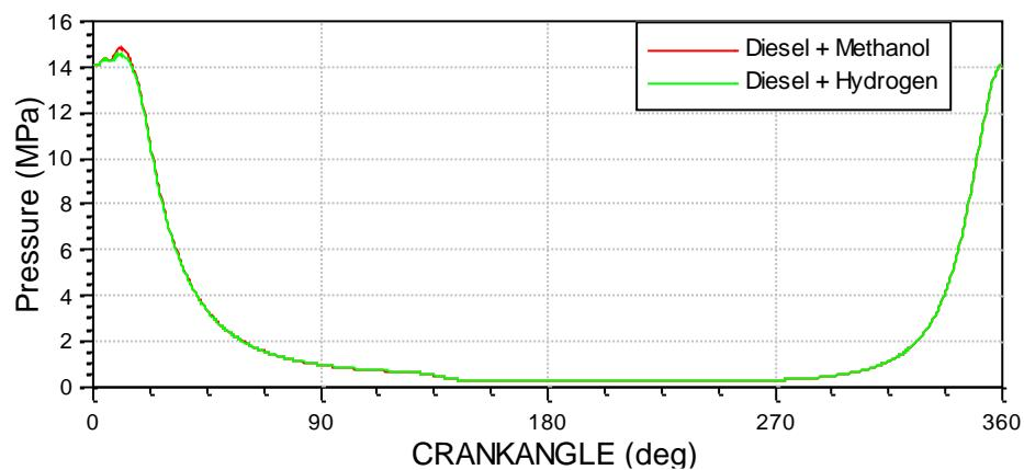
Slika 78. Rezultati simulacija tlaka smjesa metanola i vodika s dizelom
