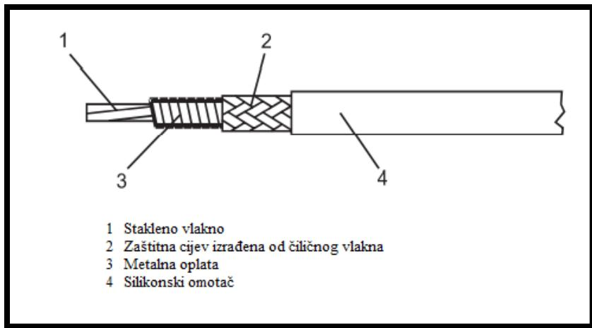
Slika 20. Optički kabel
