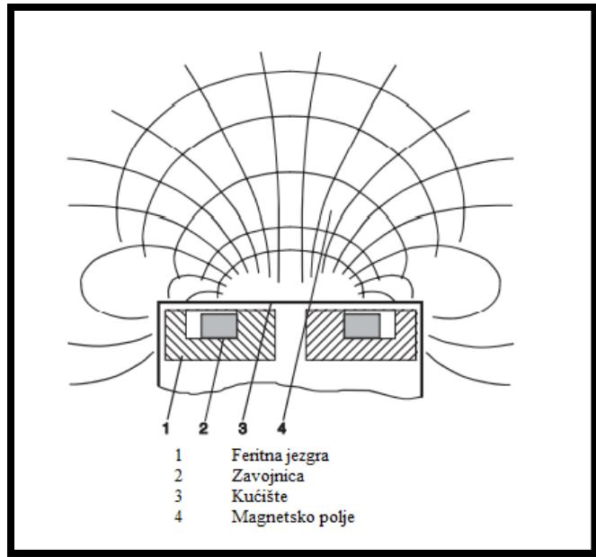
**Slika 8.** Induktivni senzor
