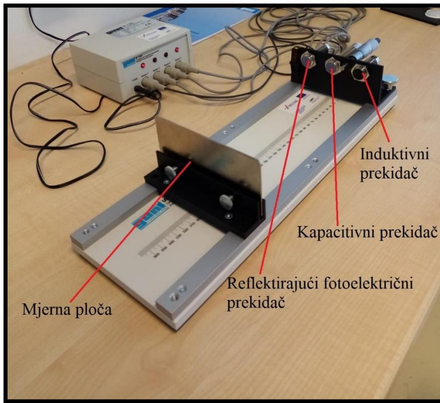
**Slika 35.** Postav induktivnog, kapacitivnog i reflektirajućeg fotoelektričnog prekidača
