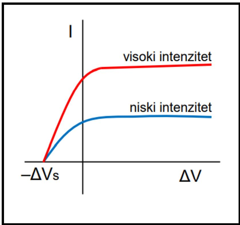
Slika 13. Ovisnost struje i napona za fotoelektrični efekt
