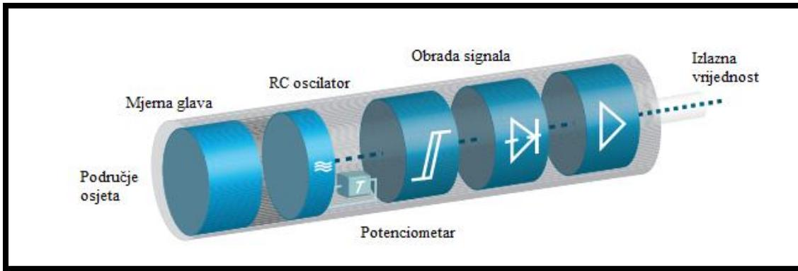
**Slika 4.** Kapacitivni senzor
