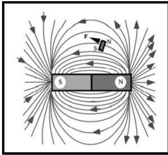
**Slika 9.** Djelovanje magnetskog polja na provodljivi materijal
