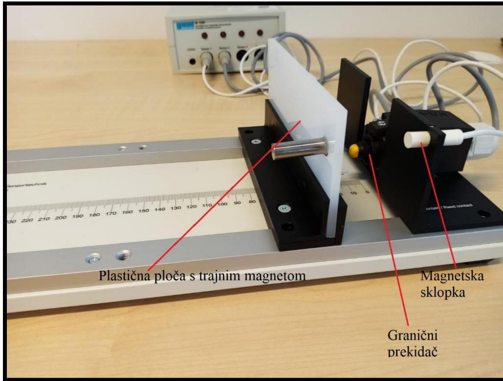
**Slika 36.** Postav graničnog prekidača i magnetske sklopke
