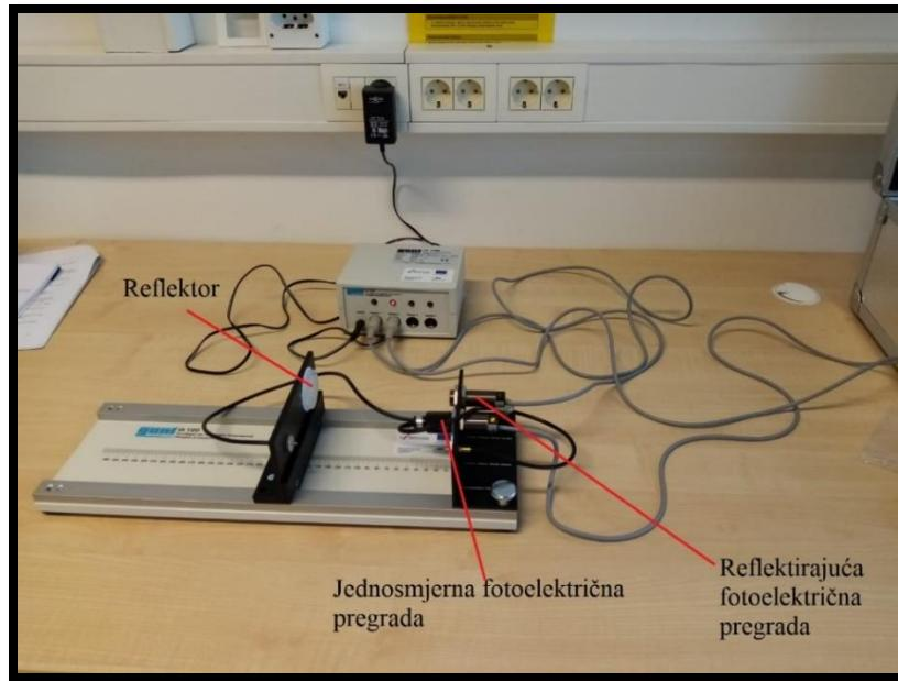
**Slika 34.** Postav jednosmjerne i reflektirajuće fotoelektrične pregrade za određivanje preklopnih udaljenosti
