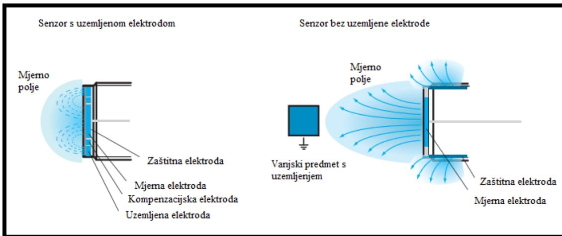
**Slika 5.** Izvedbe senzora s uzemljjenom elektrodom i bez uzemljene elektrode
