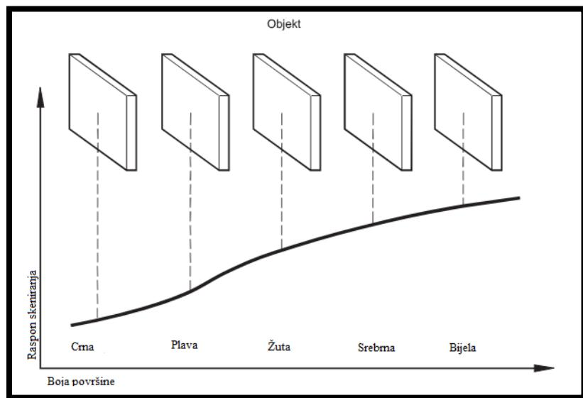
**Slika 16.** Ovisnost raspona skeniranja o boji površine
