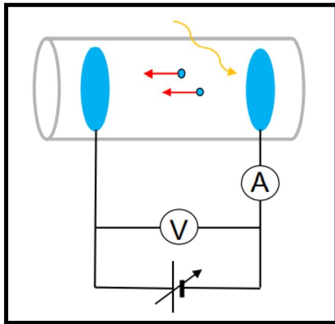
**Slika 12.** Fotoelektrični efekt
