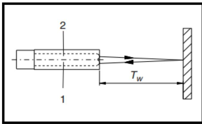
Slika 14. Reflektirajući fotoelektrični senzor
