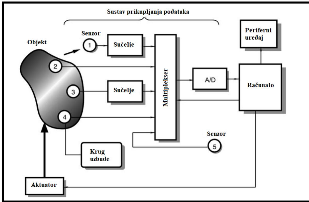
**Slika 2.** Smještaj senzora kod sustava za prikupljanje podataka
