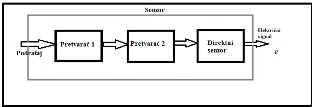
Slika 1. Senzor s dva pretvarača i direktnim senzorom koji proizvodi električni signal
