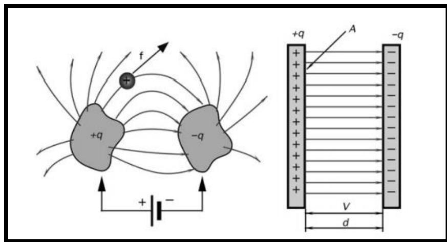
Slika 3. Električni naboј i napon između dva predmeta ili ploče
