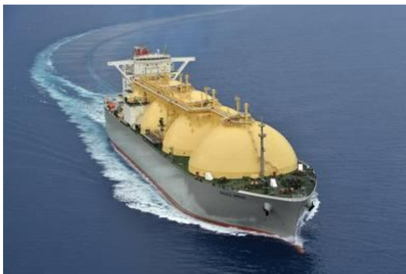
Slika 4. Najveći sferični tip broda - Pacific Breeze [11]
