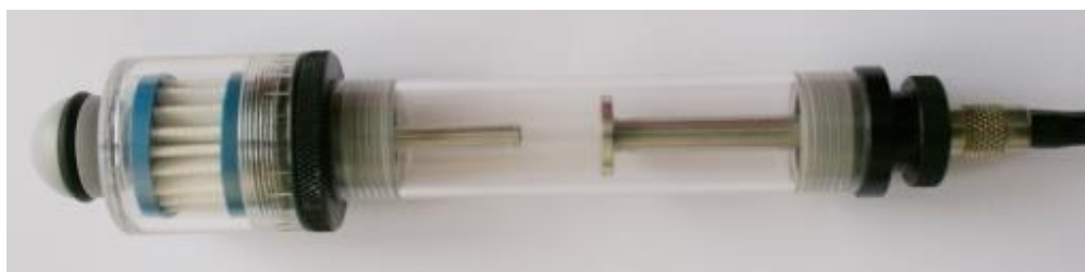
Slika 12. Odvajač kondenzata na uređaju Optima 7 NDIR [16]
