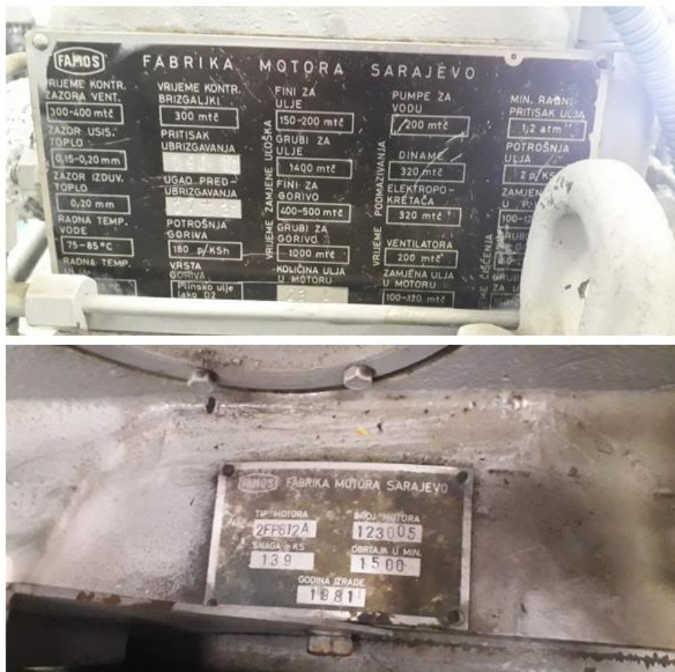
Slika 17. Tehnički podaci dizelskog motora marke FAMOS
