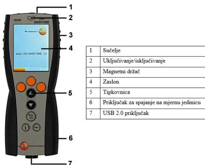
Slika 13. Kontrolna jedinica mjernog uređaja Testo 350 Maritime [19]
