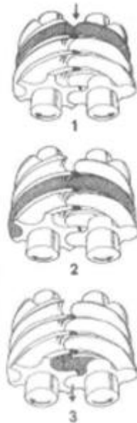
Slika 11. Radni taktovi kompresora [11]
