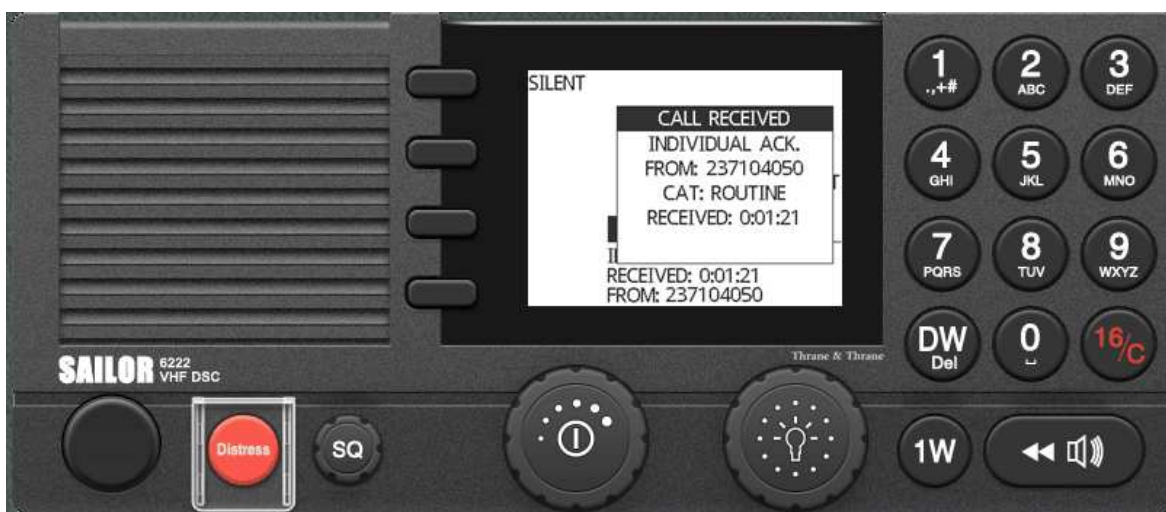
Slika 20. VHF uređaj broda m/v Helena prima poziv od broda m/v Europe
