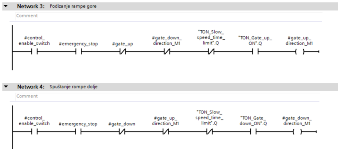
Slika 22. Podizanje i spuštanje rampe
